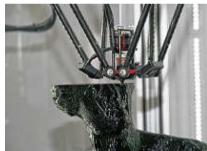
Nahaufnahme: Die Druck-Apparatur kreist geschmeidig über dem Kopf der Statue.
