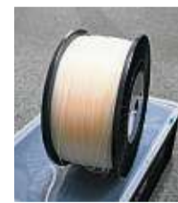
Das Druckmaterial: Fast drei Kilometer eines speziellen Kunststoffs, aufgewickelt auf einer Rolle.
